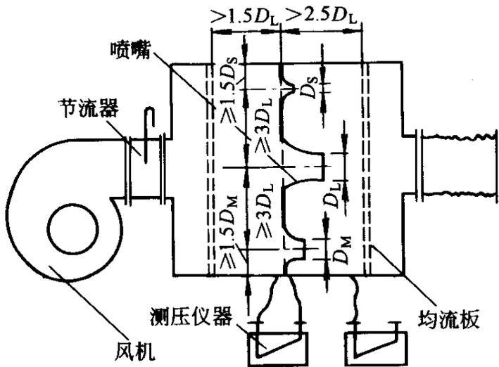
图 A. 2. 7-1 正压风室式漏风量测试装置
