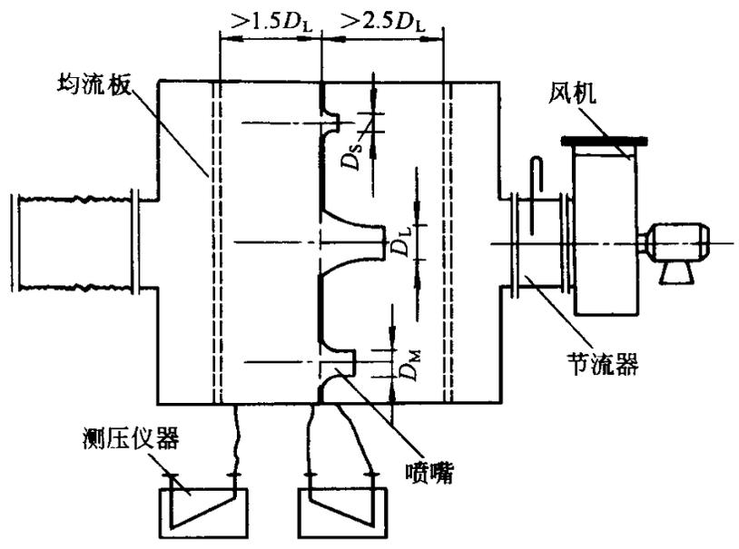
图 A. 2. 7-4 负压风室式漏风量测试装置
