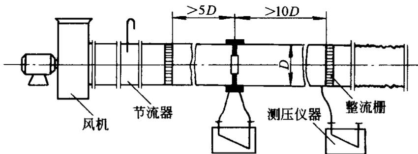
图 A. 2. 6-3 负压风管式漏风量测试装置
