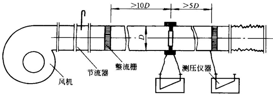
图 A. 2. 6-1 正压风管式漏风量测试装置
